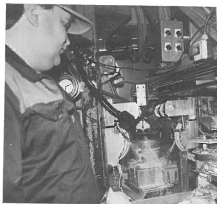
Stanslinjen för röjsågklingor har byggts ihop med en automatisk sliputrustning för tänderna, som här övervakas av Lars-Göran Nymans.
