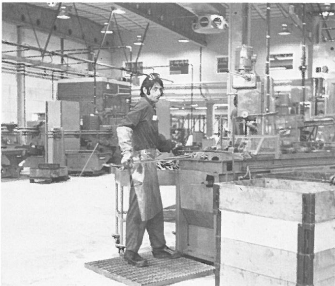
Maskiner för skiftnyckelbearbetning i mekaniska verkstaden. Närmast en dragbänk för större skiftnycklar betjänad av Francesco Vinci. Till vänster skymtar 2 st nya 6-spindliga svarvautomater för tillverkning av ställskruven.
