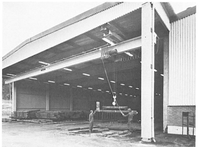
Materialförrådet med travers på 3,2 ton för lossning av material från bilar och för hantering över till förrådsytan.
