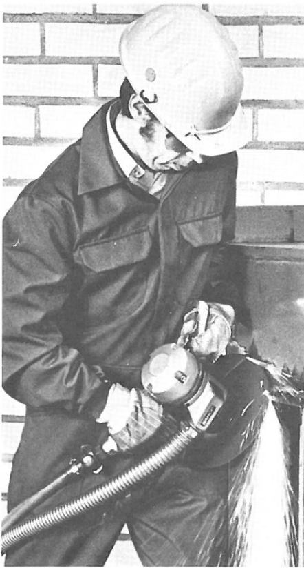
Här en 9" maskin, SK 3-60, i arbete. Försedd med en speciell ljuddämpningsanordning som reducerar ljudnivån till 71 dbA.
