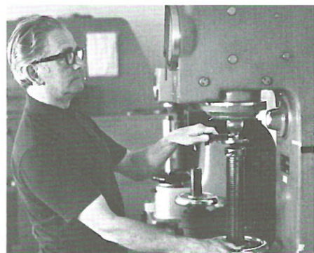
Olle Pransjö provar hårdheten i ett skiftnyckelhuvud.
