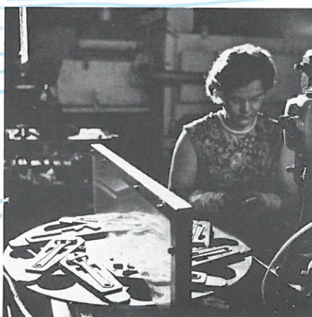
Överflödigt material skäggas bort, skaftet riktslås och ojämnheter efter skäggningsen borttages.
