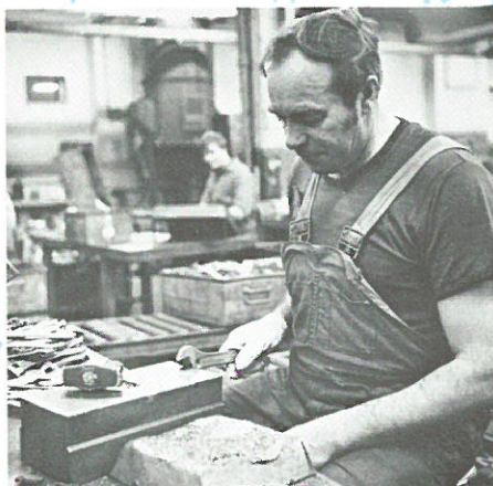
I monteringsavdelningen sker hopsättning av skiftnycklar. Här möts skaft, löpare, ställskruv och stift.
