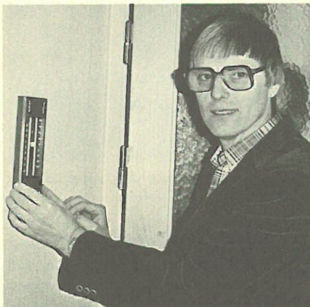
Lars-Eric Thor avläser här en termometer, som visar både min- och maxtemperaturen i ett arbetsrum under ett dygn.
