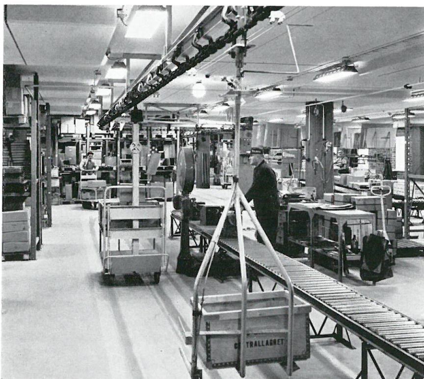
I det nya centrallagret har Bahco Erenco byggt upp en sluten overhead-conveyorbana
