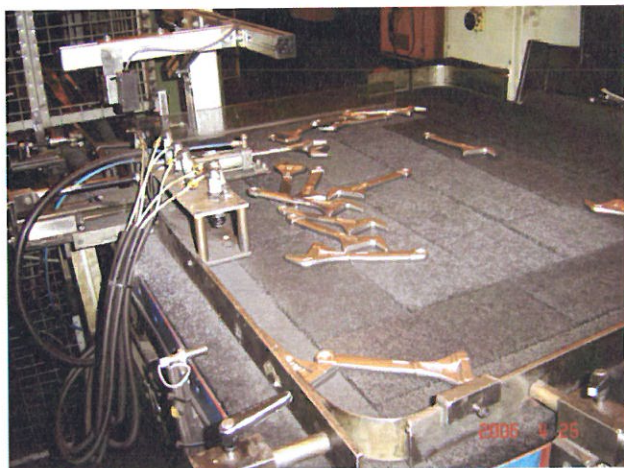
Orienteringsbord vid robotline för slipning.
