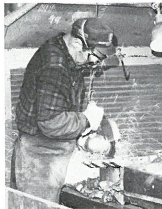
Kapning med handhållen maskin. Utsugningen sker genom gallret i bakgrunden.
