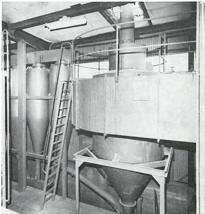
En av vindsiktarna för spånsortering. Det osorterade spånät kommer in upptill (här från en ovanförliggande vindsikt). Siktluften tillförs genom kanalen mitt på bilden. Grovfraktionen tas ut i vindsiktens spets och vidarebefordras pneumatiskt till förnyad malning. Finfraktionen, som är nytospånät, kommer genom ett uttag på den koniska mantelytan (skymt på bilden).
