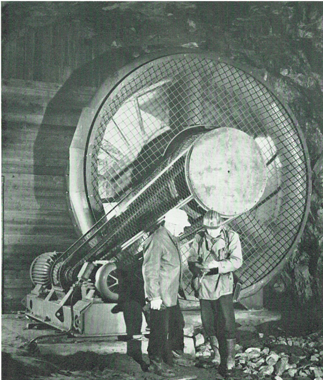
Frånluftsfläkt för gruvan i Stripa (Ställbergs Grufve AB). Fläkten är av typ PMK 315, försedd med diffusor på utloppet.
