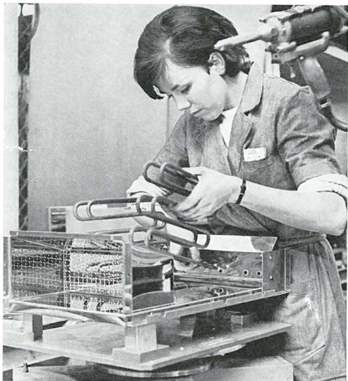
De helkapslade värmespiralerna monteras. Närmast kameran syns stenmagasinet.
